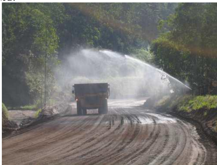
Figura 2 - Sistema de Despoeiramento Automatizado Da Indústria Vale - Mina De Água Limpa - Rio Piracicaba / MG.
