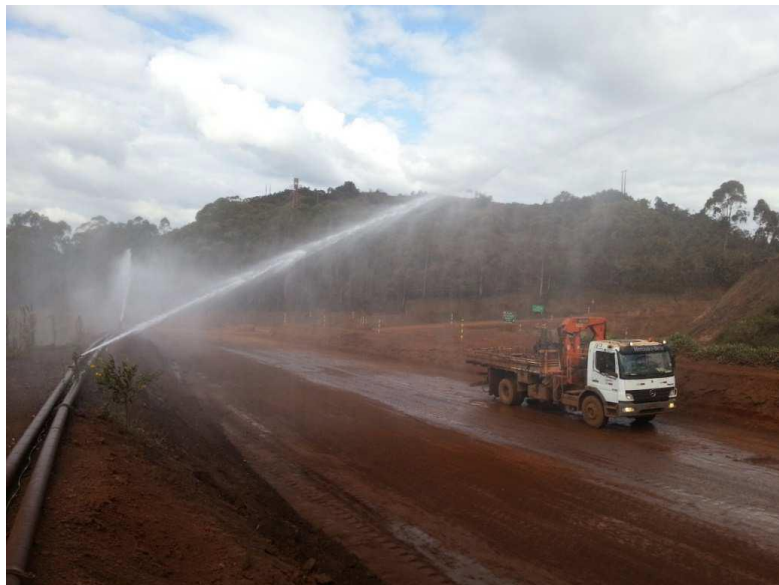
Figura 3 - Sistema de Despoeiramento Automatizado Da Indústria Vale - Mina De Fábrica - Congonhas / MG.
