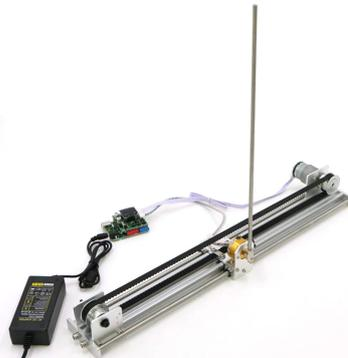
Fonte: Ip570 pêndulo invertido linear rotativo
