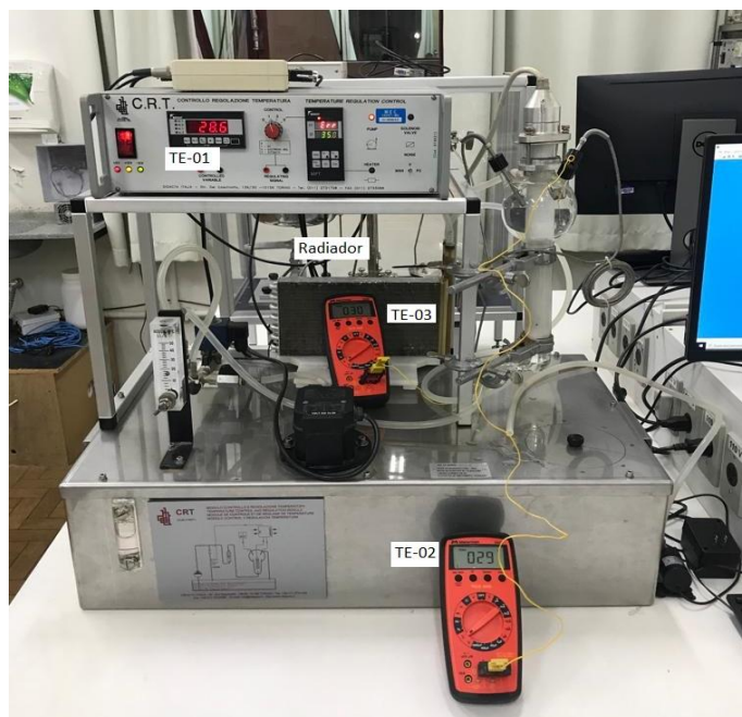
Figura 13 – Primeira montagem (radiador e termopares)
