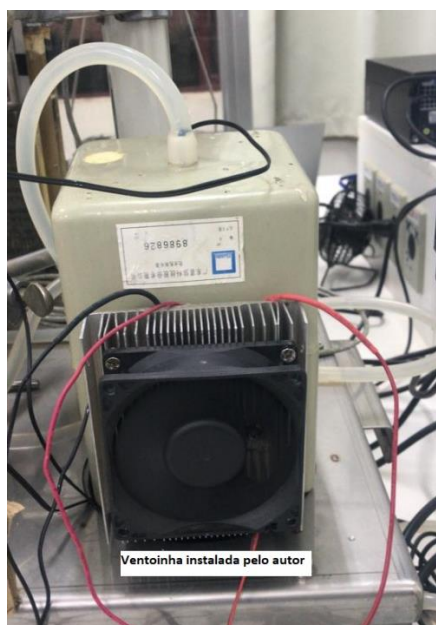
Figura 17 - Tanque de Água Gelada com Placa de Peltier
