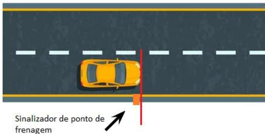
Figura 18 – Sinalizador de ponto de frenagem
