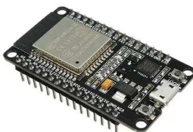
Figura 5 – Placa de desenvolvimento com ESP32
