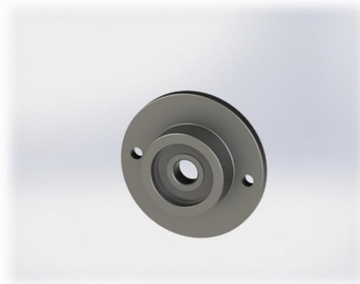
Figura 3.5: Imagem renderizada do mancal com rolamento 6001 do fuso dos eixos X, Y e Z.
