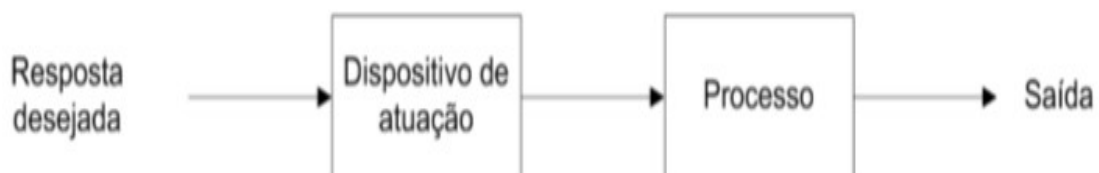
Figura 4 - Sistema de controle de malha aberta.
