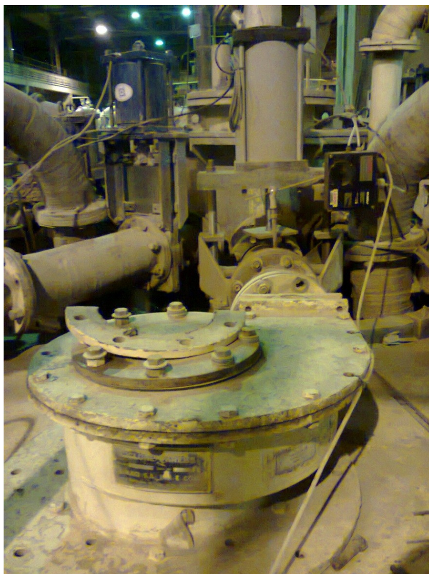
Figura 21 – Hidrociclone modificado, retirados APEX e Vórtex e flangeado o Overflow.
