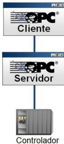
Figura 19 - Arquitetura cliente-servidor OPC Fonte: PUDA, 2008.
