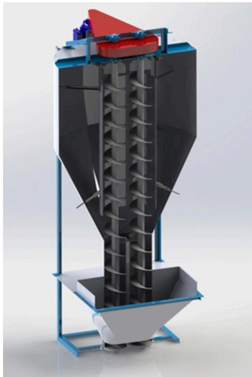
Figura 17 - Misturador vertical com dois helicóides.
