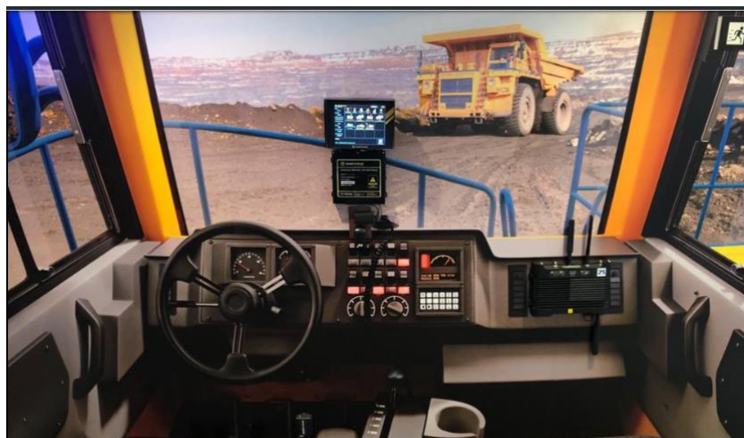
Figura 7 - Sistema Easymine instalado em um caminhão fora de estrada.
