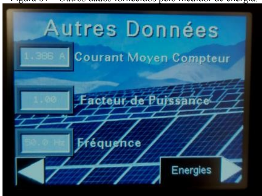
Figura 61 – Outros dados fornecidos pelo medidor de energia.
