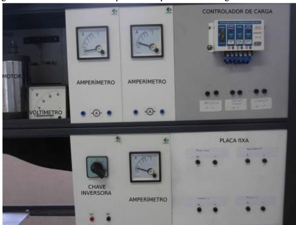
Figura 9 – Bancada didática experimental para uso de energia eólica e fotovoltaica.
