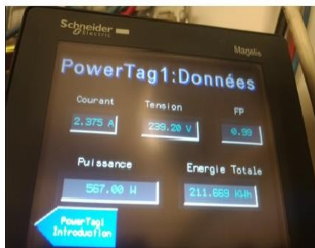
Figura 58 – Janela de dados para o consumo de energia e IHM com carga de 570 W.
