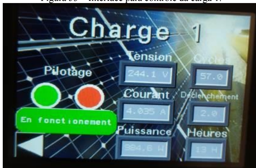
Figura 53 – Interface para controle da carga 1.
