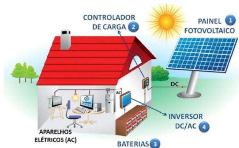
Figura 5 - Sistema fotovoltaico off-grid .
