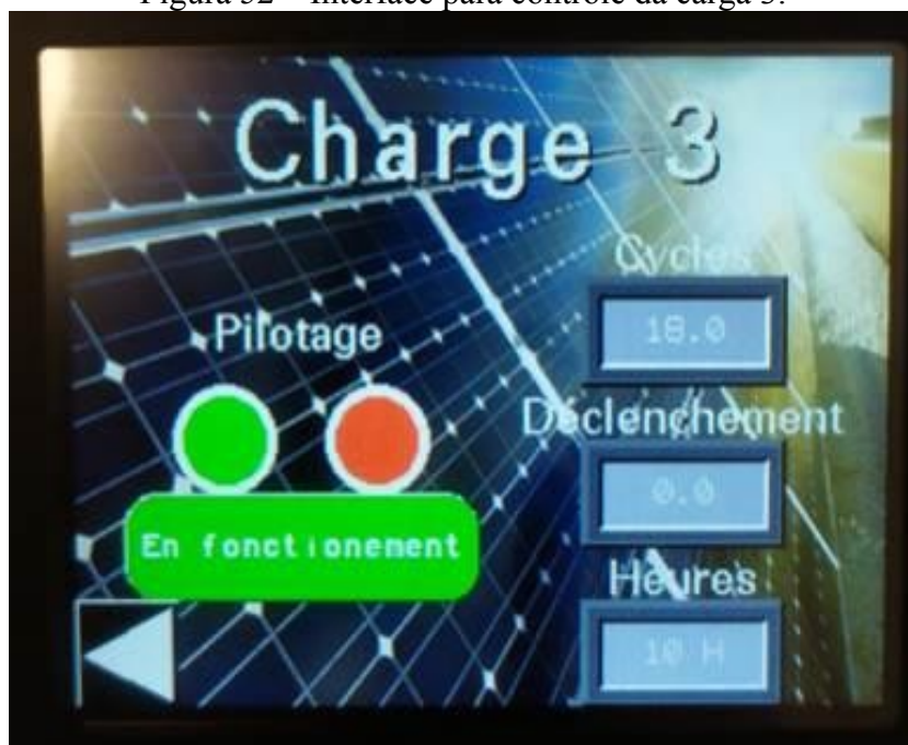
Figura 52 – Interface para controle da carga 3.
