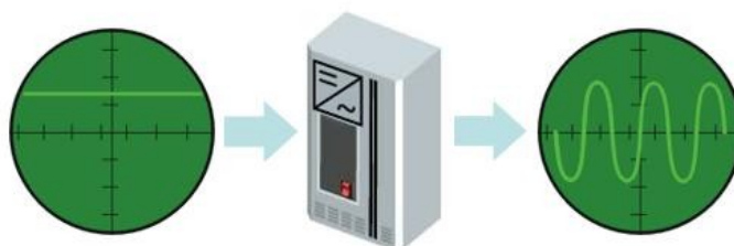
Figura 6 – Ilustração de um conversor eletrônico de potência CC/CA.
