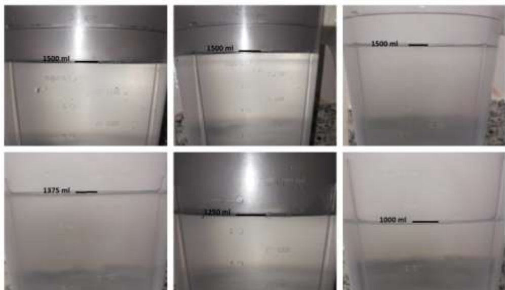
Figura 48 – Volume armazenado até se obter 56°C, no banheiro social, da Residência 2.
