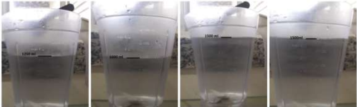
Figura 45 – Volume armazenado até se obter 56°C, no banheiro social, da Residência 2.
