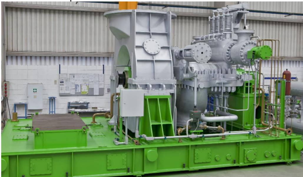
Figura 3 – Turbina a vapor.
