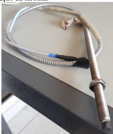
Figura 34 – Sensor de vibração da turbina.
