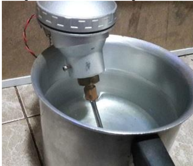
Figura 53: PT100 inserido em água de 100°C
