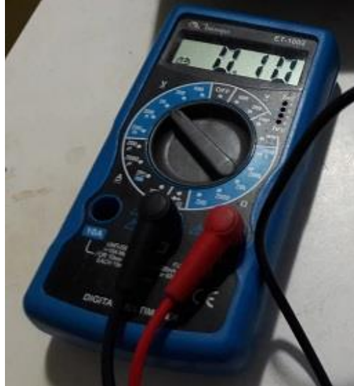
Figura 47: Multímetro com o PT100 em 0°C
