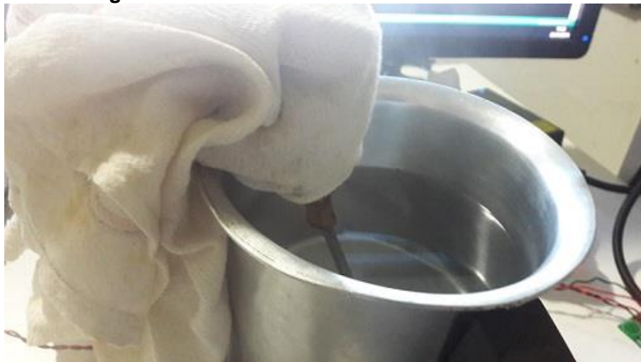
Figura 48: PT100 inserido em amostra de 100°C
