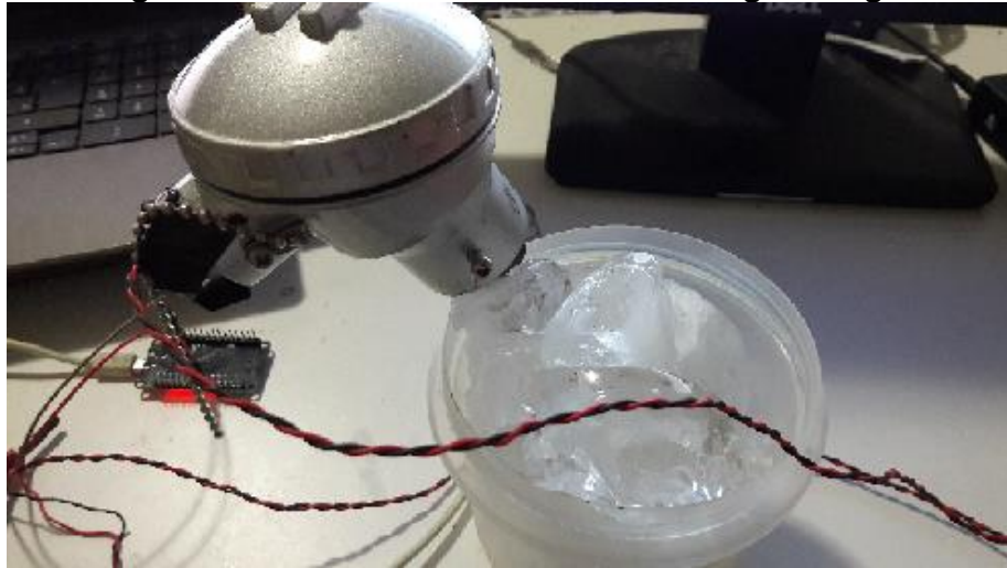
Figura 45: PT100 inserido em amostra de gelo e água
