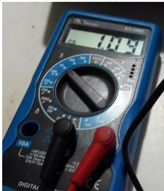
Figura 50: Multímetro com o PT100 submetido a 100°C
