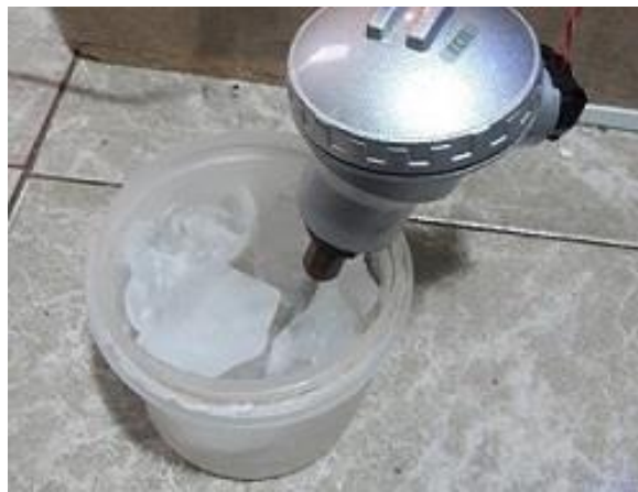
Figura 51: PT100 inserido em água em gelo fundente
