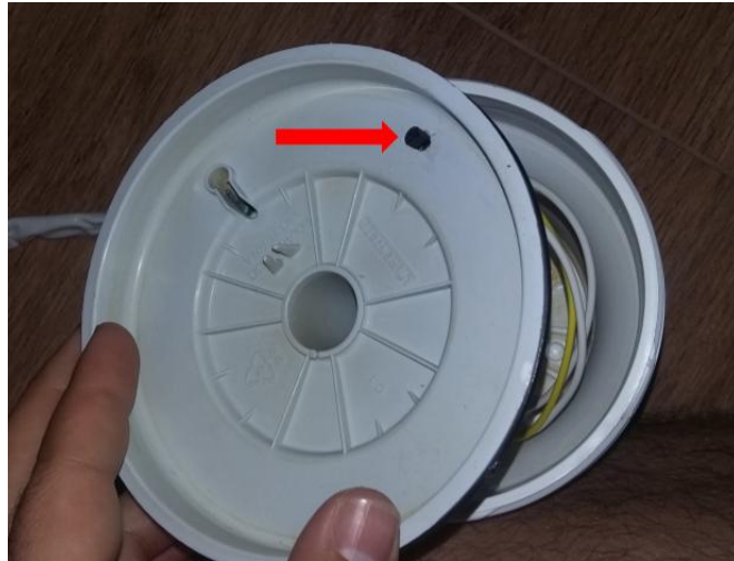
FIGURA 29 - Sensor montado no chuveiro.
