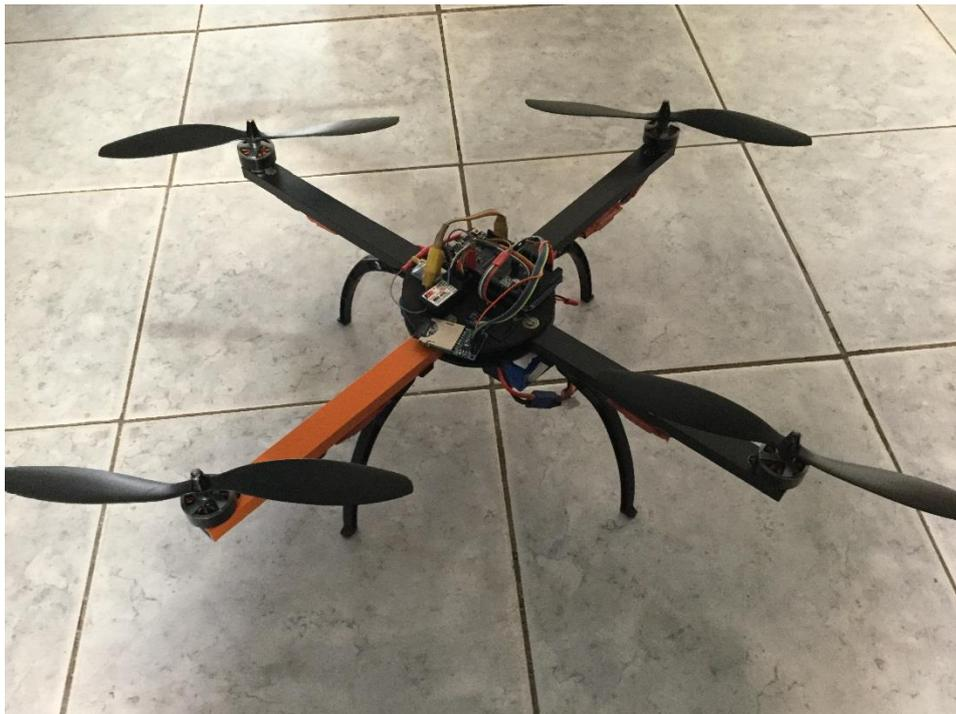
Figura 20 – Quadricóptero utilizado no projeto.
