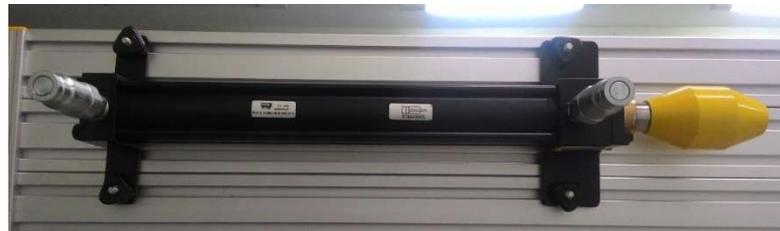
Atuador hidráulico linear de dupla ação, figura 27, com diâmetro de 38 mm e curso de 200 mm, com conexões de engate rápido com sistema antivazamento de 3/8" para pressão até 3000PSI e montado em base apropriada para fixação no painel didático em perfil de alumínio de 30x60mm, sem a utilização de ferramentas.
