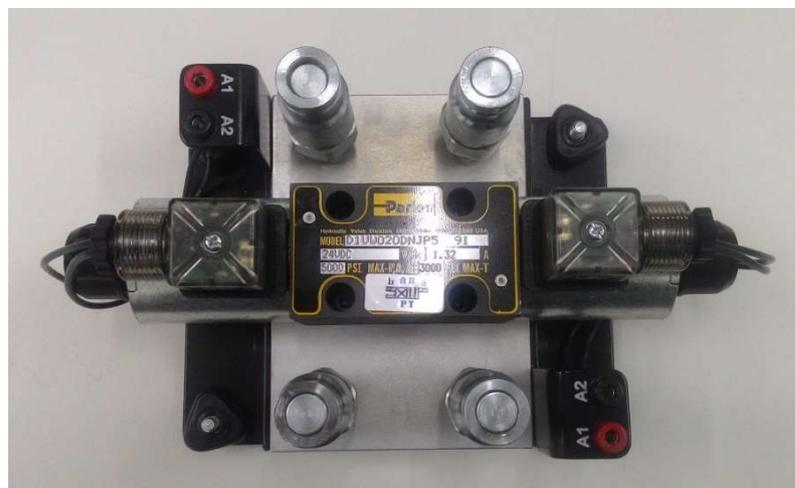
Válvula direcional 4/3 vias, figura 30, duplo solenoide, centrada por mola, com bornes de ligação rápida de cabos elétricos para pinos do tipo banana com diâmetro de 4mm, com conexões de engate rápido com sistema antivazamento de  $\text{Ø}3/8''$  para pressão até 3.000 PSI e montado em base apropriada para fixação no painel didático em perfil de alumínio de 30 x 60mm, sem a utilização de ferramentas.
