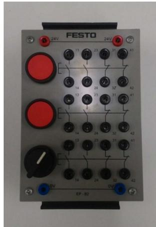
Bloco de contatores, figura 21, formado por 03 (três) contatores, sendo cada um composto por 04 (quatro) opções de contatos NF e 04 (quatro) contatos NA, com bornes de ligação rápida de cabos elétricos para pinos do tipo banana com diâmetro de 4mm. Sua função no sistema é energizar o grupo que deverá estar ativo.
