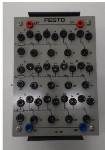
Bloco de temporizadores, figura 22, formado por 02 (dois) temporizadores, sendo cada um composto por 01 (um) contato NF e 01 (um) contato NA, com escala de 0,5 a 30s, com bornes de ligação rápida de cabos elétricos para pinos do tipo banana com diâmetro de 4mm. Sua função no sistema é energizar o grupo que deverá estar ativo.
