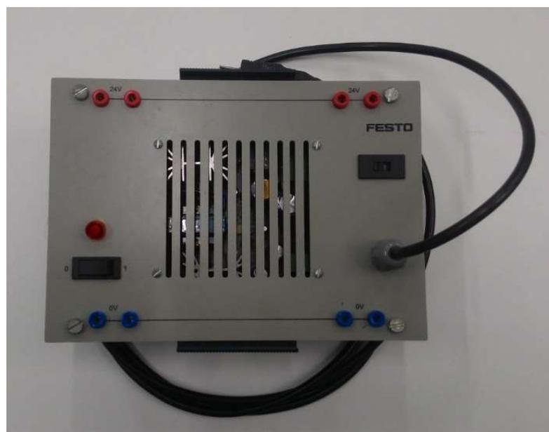
Bloco “STARTER”, figura 20, composto por 02 (dois) botões de impulso e 01 (uma) chave seletora, sendo cada um composto por 02 (dois) contatos NA e 02 (dois) contatos NF, com bornes de ligação rápida de cabos elétricos para pinos do tipo banana com diâmetro de 4mm. Durante a realização do trabalho, foi utilizado apenas a chave seletora. Sua função é habilitar ou desabilitar o funcionamento do sistema.
