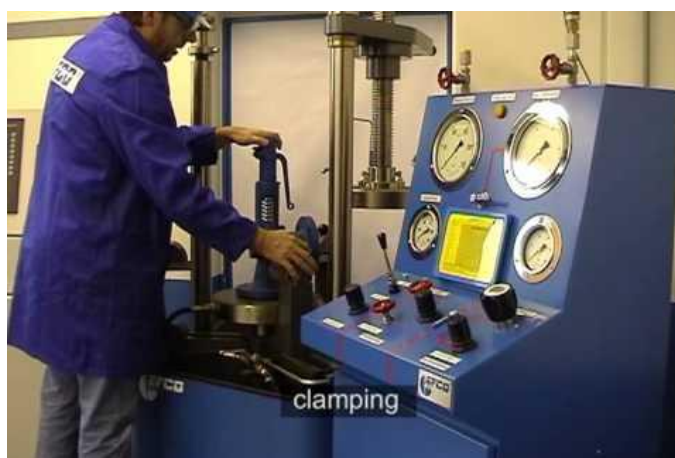
Figura 26 - Calibração de uma válvula de segurança
