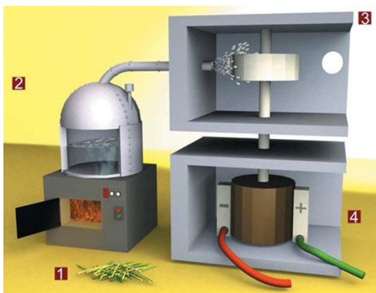
Figura 2 – Representação esquemática de uma termoelétrica
