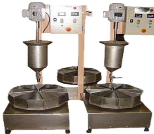
Figura 11 - Quarteador de polpa úmido. Fonte: CDC ind.
