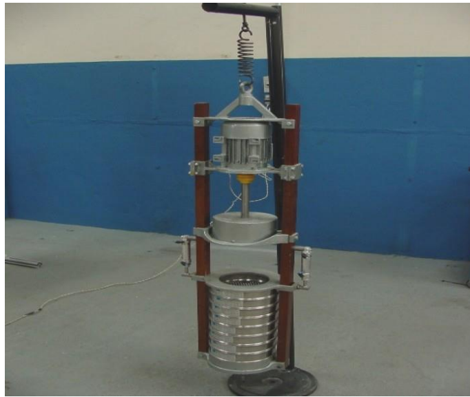
Figura 12 - Peneirador vibratório automático. Fonte: Engendrar ind.
