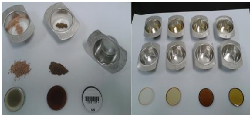
Figura 16 - Cadinhos de platina: Minérios após fusão.
