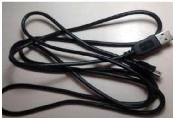
**Figura 23** - Cabo USB / Mini USB
