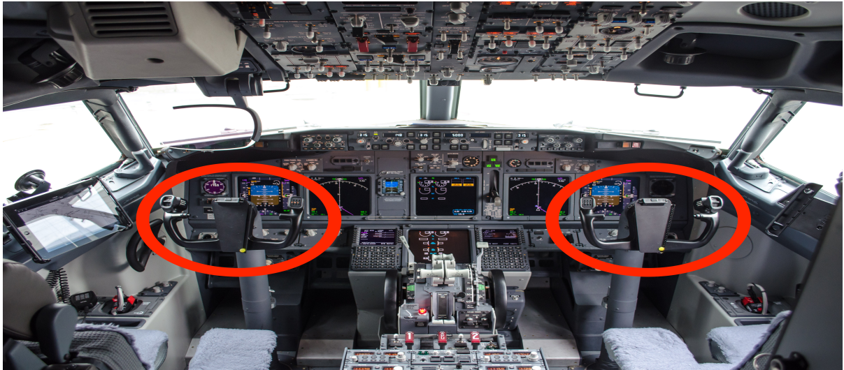
Figura 16 - Cockpit de um Boeing 737-800 e seus Manches (Yoke) em destaque. Fonte: Adaptado de WALLPAPER SAFARI (2017).
