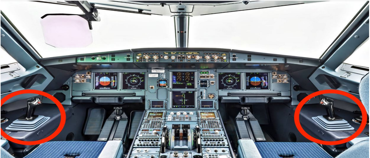
Figura 15 - Cockpit de um Airbus A320 e seus Sidesticks em destaque. Fonte: Adaptado de GEEK (2016).
