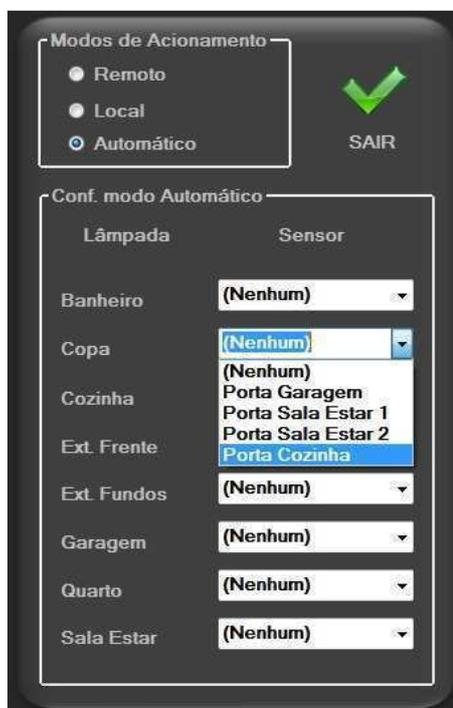
**Figura 62 – Configuração das lâmpadas no modo automático.**
