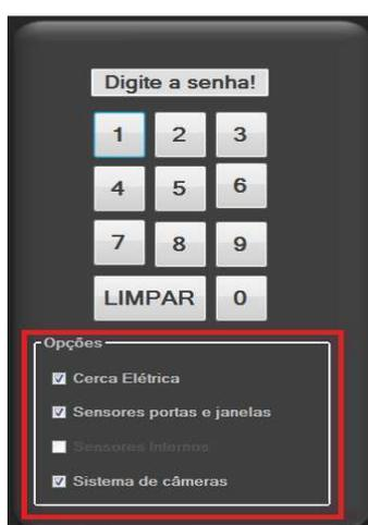
**Figura 46 – Teclado senha ativação do sistema de alarme.**
