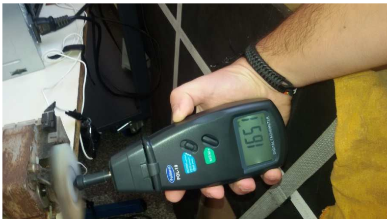
Figura 65: Medição realizada com o Tacômetro Digital de 1.651rpm
