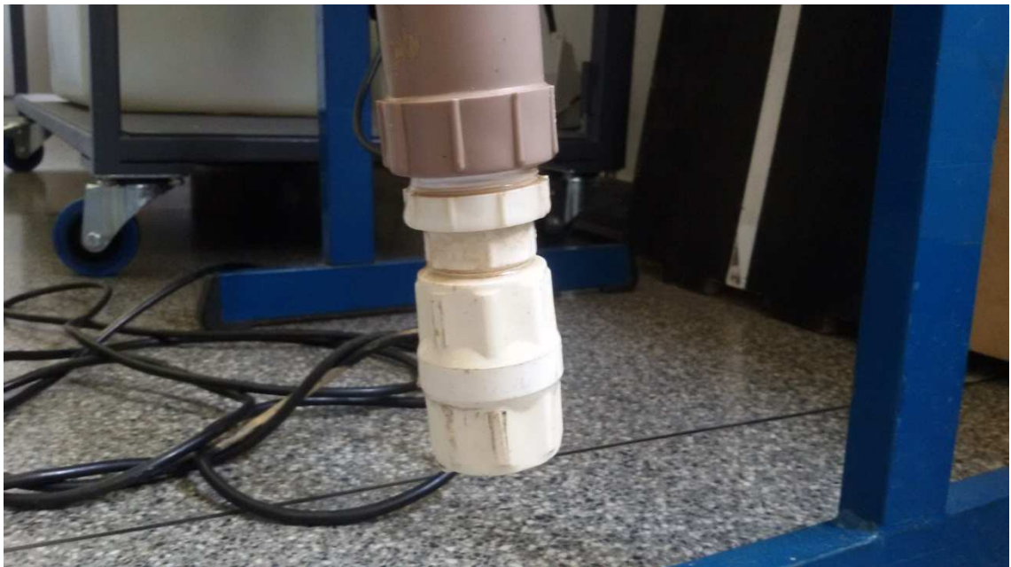
Figura 27: Detalhe de uma válvula de pé com crivo
