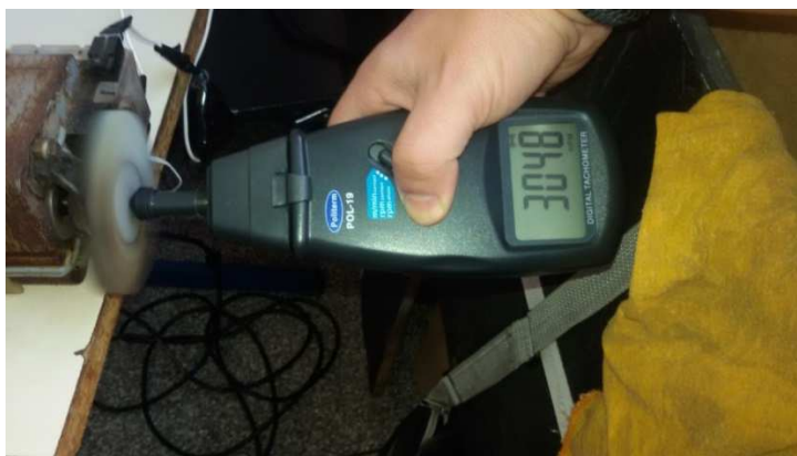
Figura 64: Medida de 3.048rpm realizada com o Tacômetro digital
