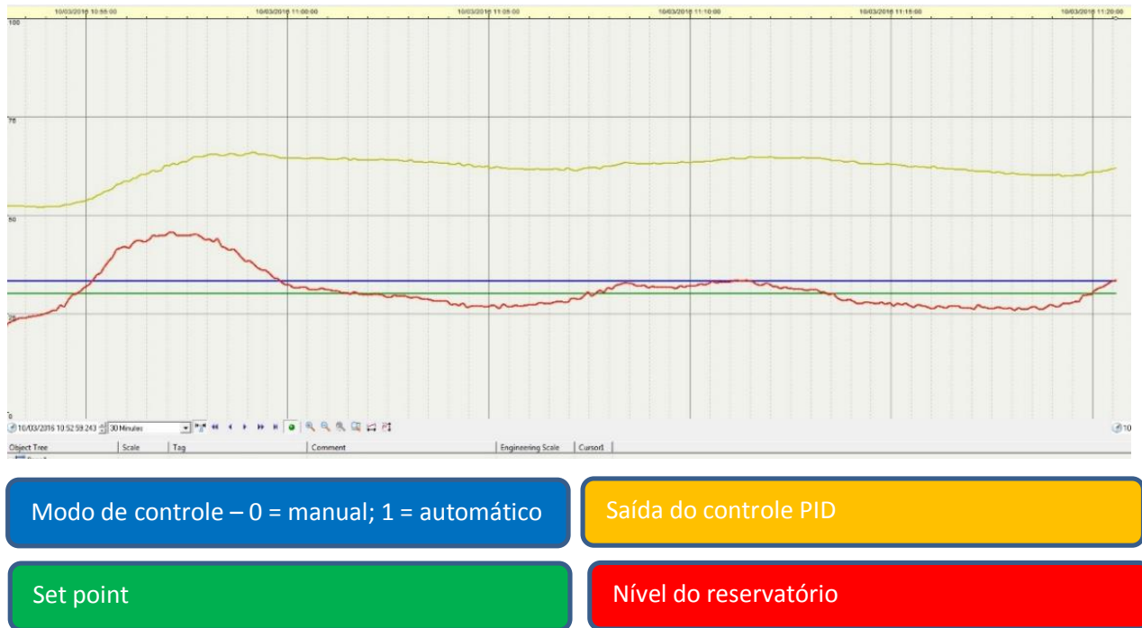
Figura 32: Controle em automático sistema com controle dedicado
