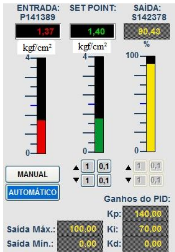
Figura 35: Controle em automático através do sistema com controle dedicado
