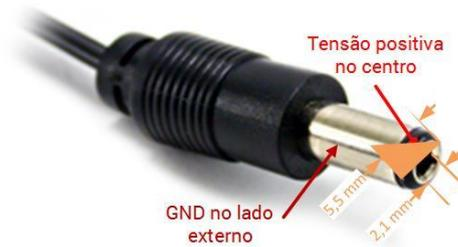
Figura 11 - Plugue fêmea 2,1 mm para alimentação do Arduino.
