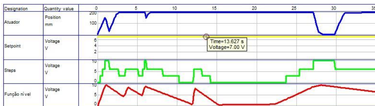
Figura 59: Gráfico de simulação da resposta do atuador em função aleatória do nível.
