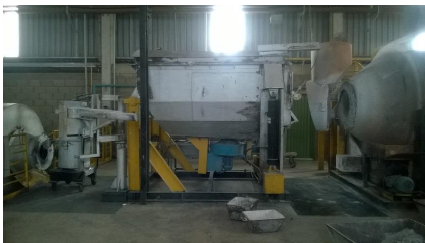
Figura 1: Cadinho e forno de espera. Fonte: FBM (Fábrica Brasileira de Metais).
