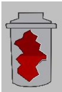
Figura 54: Representação do cadinho e do nível do cadinho no supervisório.
