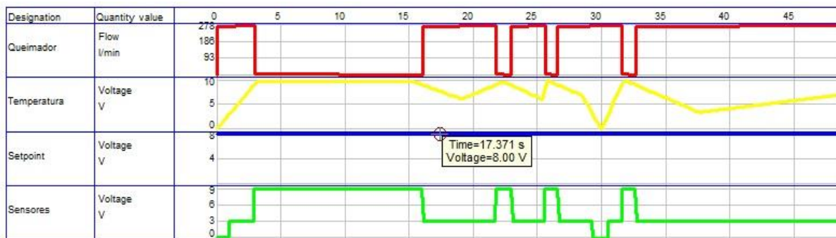
Figura 65: Gráfico de simulação do controle da temperatura do forno em função aleatória.
