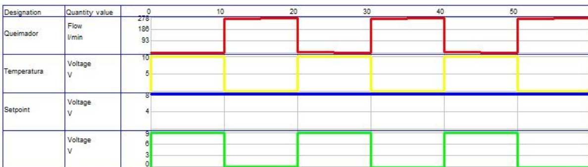
Figura 64: Gráfico de simulação do controle da temperatura do forno em função retangular.
