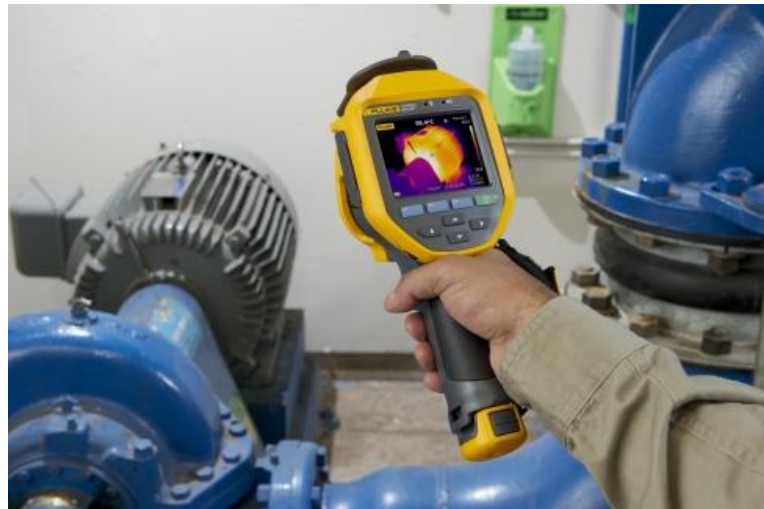
FIG. 1 - Manutenção Preditiva de termografia. Fonte: AresAgante (s.d.).
