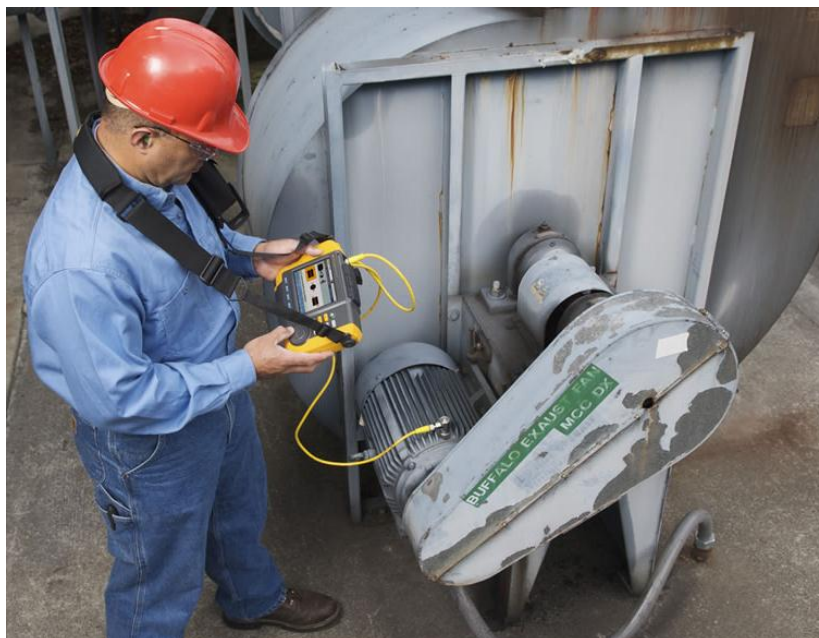
FIG. 3 - Manutenção Preditiva de vibração. Fonte: Vieira Balanceamentos (s.d.).
