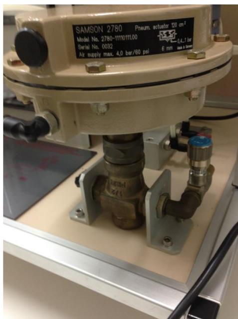
Figura 6: Atuador pneumático
