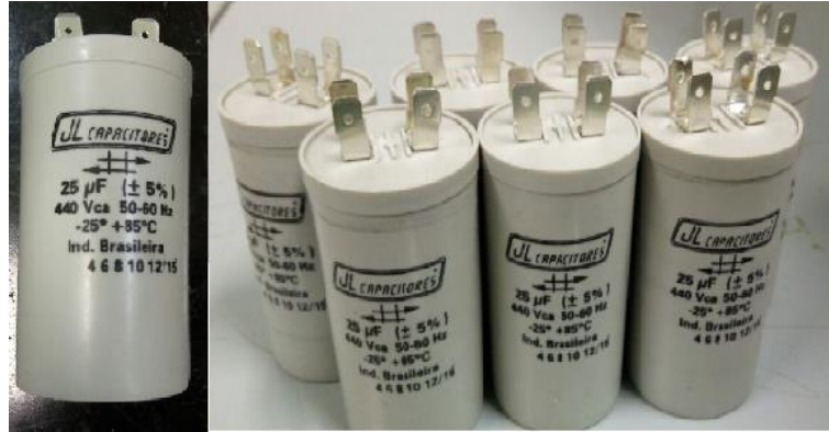
Figura 30: Capacitores de 25 uF utilizados no circuito.
