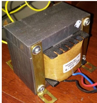
Figura 19: Transformador utilizado no projeto.
