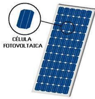
Figura 3: Montagem de uma placa fotovoltaica.
