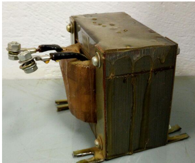
Figura 31: Indutor de 33 uH utilizado.
