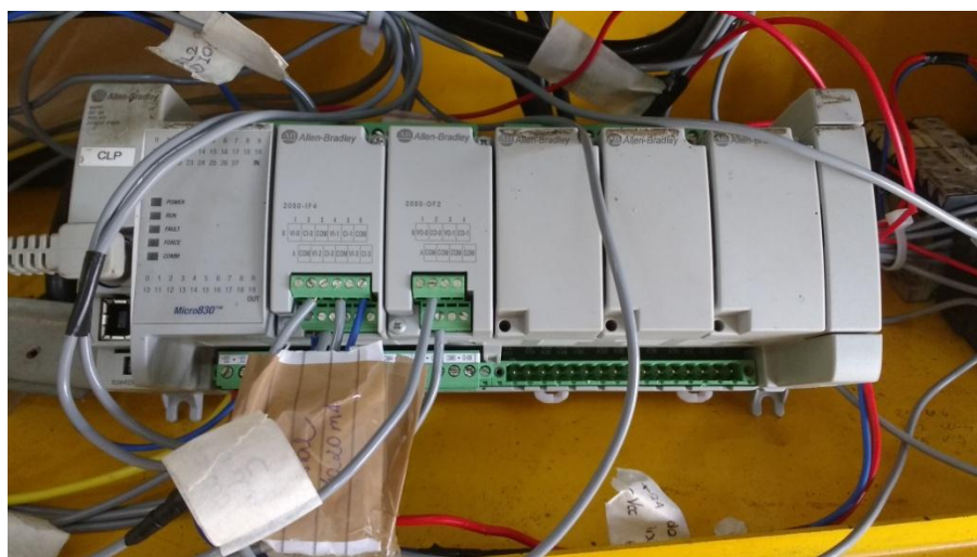
Figura 10 - CLP acrescido do cartão de entrada e saída analógicos.
