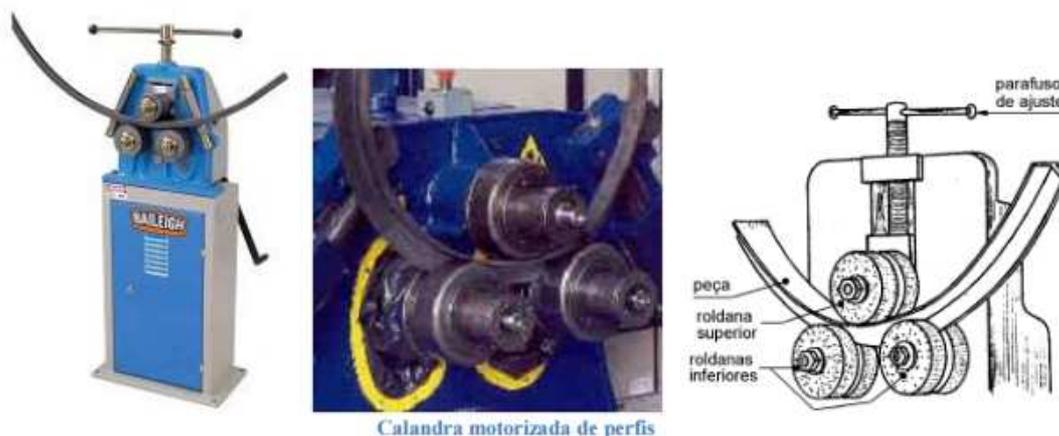
FIGURA 16 - Exemplificação de Calandra Motorizada de Perfis Metálicos
