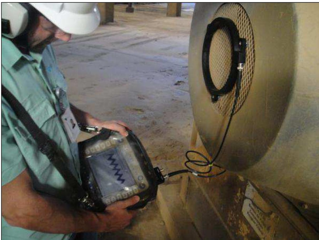
Figura 210 - Processo de coleta do fluxo magnético
