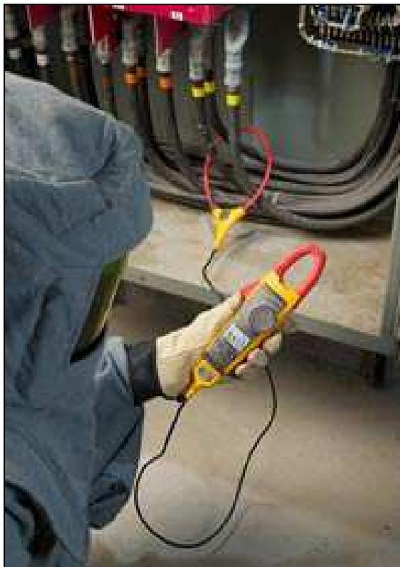
Figura 17 – Coleta de amostra de corrente
