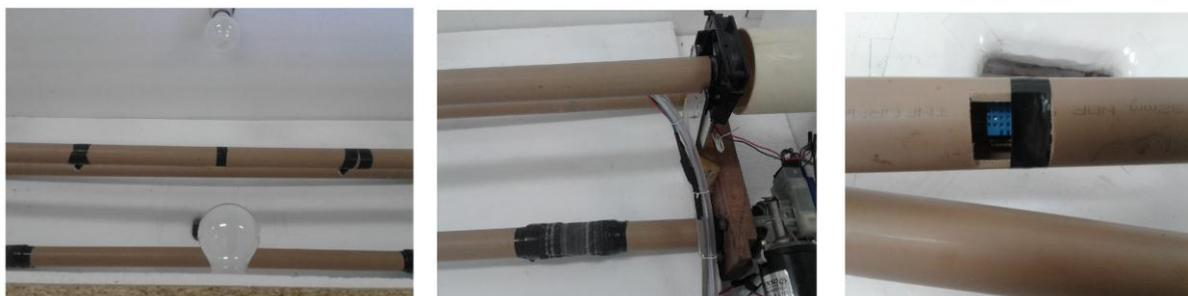
Figura 28 - Detalhes da posição do sensor de temperatura e umidade.
