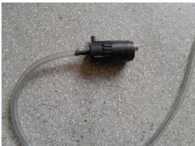
Figura 18 - Bomba de limpador de para-brisas.
