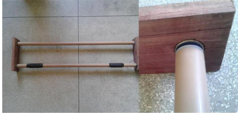
Figura 20 - Estrutura de suporte do cilindro.
