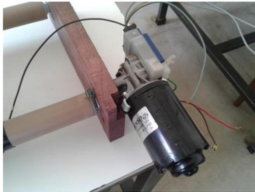
Figura 21 - Motor de limpador de para-brisa.
