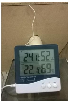
Figura 62 - Sensor utilizado para aferir os registros (termo-higrômetro).
