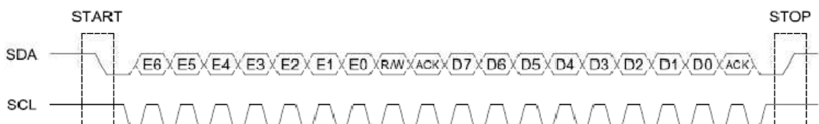
FIGURA 4 – Comunicação com endereçamento de 7 bits e envio/leitura de um pacote de dados Fonte: Adaptada pelo autor (MIYADAIRA, 2009, p. 293).
