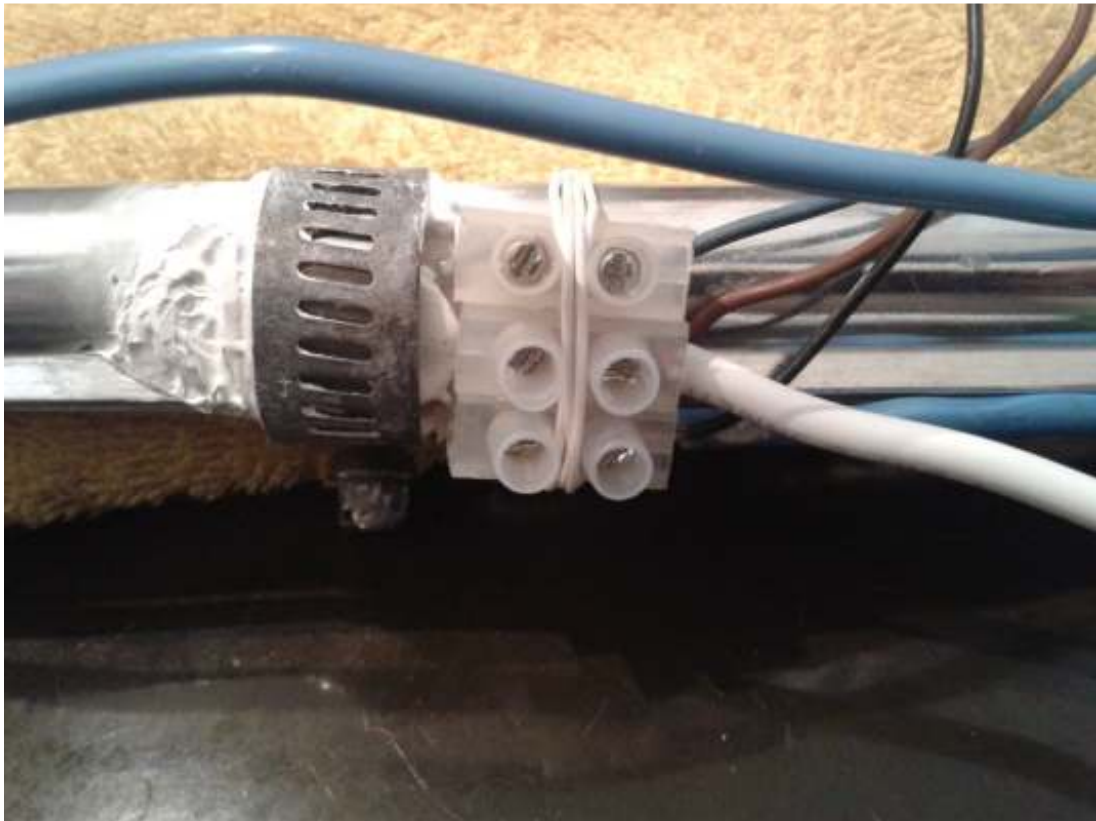
Figura 32 - Fixação do atuador (TRIAC) para dissipação do calor Fonte: do autor.
