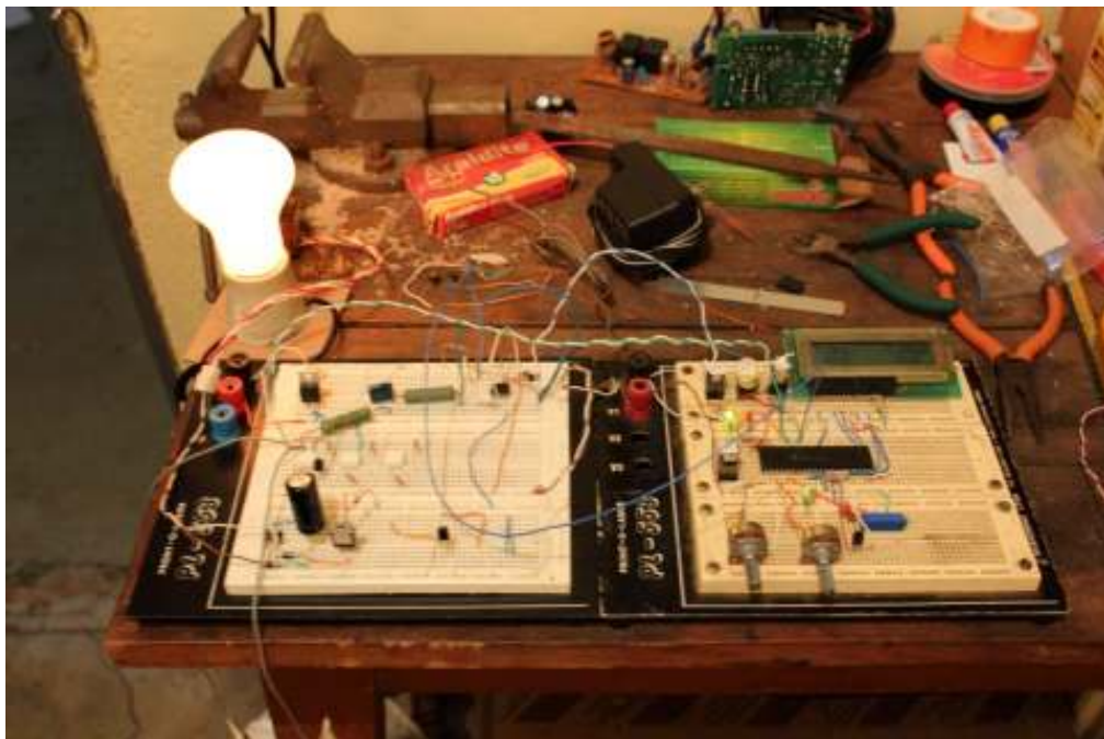
Figura 24 - Circuito do controlador em protoboard Fonte: do autor.
