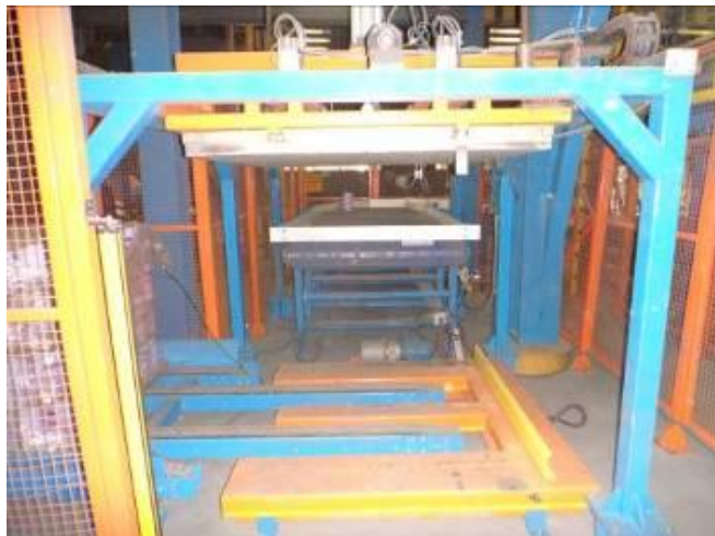
Figura 26 - Despaletizador de latas
