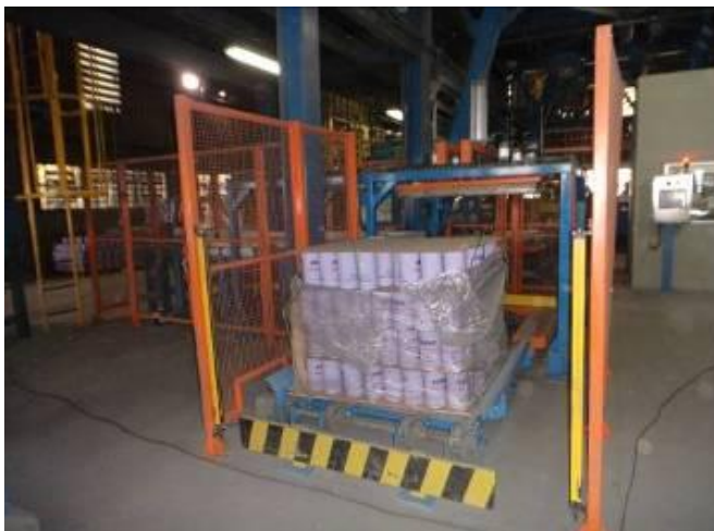
Figura 25 - Alimentação de latas no início do processo
