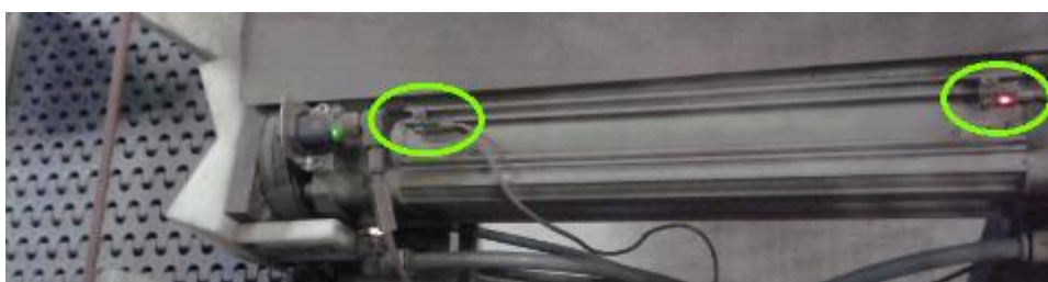
Figura 19 - Sensores magnéticos acoplados no cilindro pneumático
