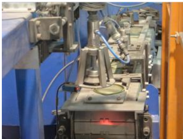
Figura 32 - Imagem da ventosa e da esteira de tampas
