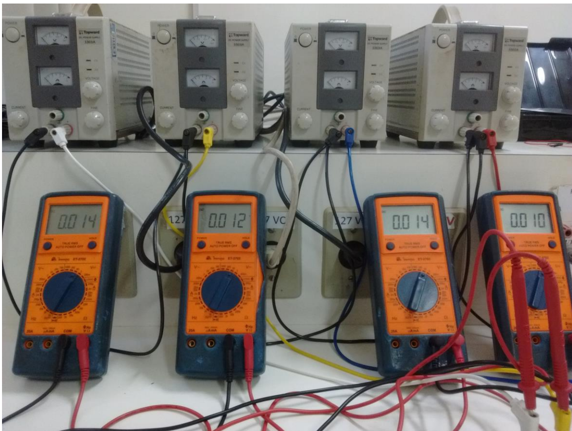
Figura 24: Tensão de 0 Volts aplicada nas entradas analógicas do Arduino.
