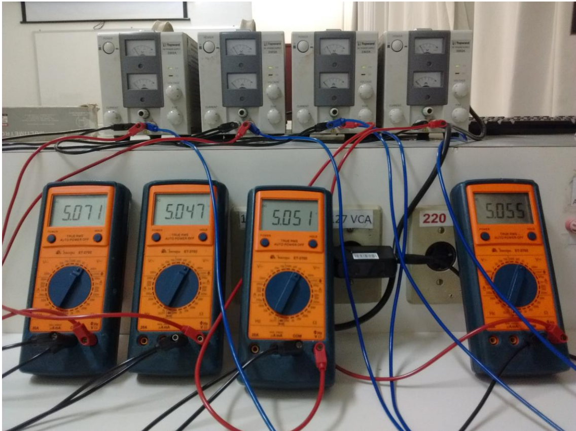
Figura 28: Tensão de 5 Volts aplicada nas entradas analógicas do Arduino.
