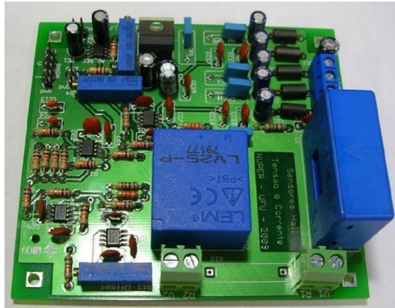
Figura 6: Módulo de Aquisição e Condicionamento de Sinais de Tensão/Corrente. Fonte: NUPEP (2011).
