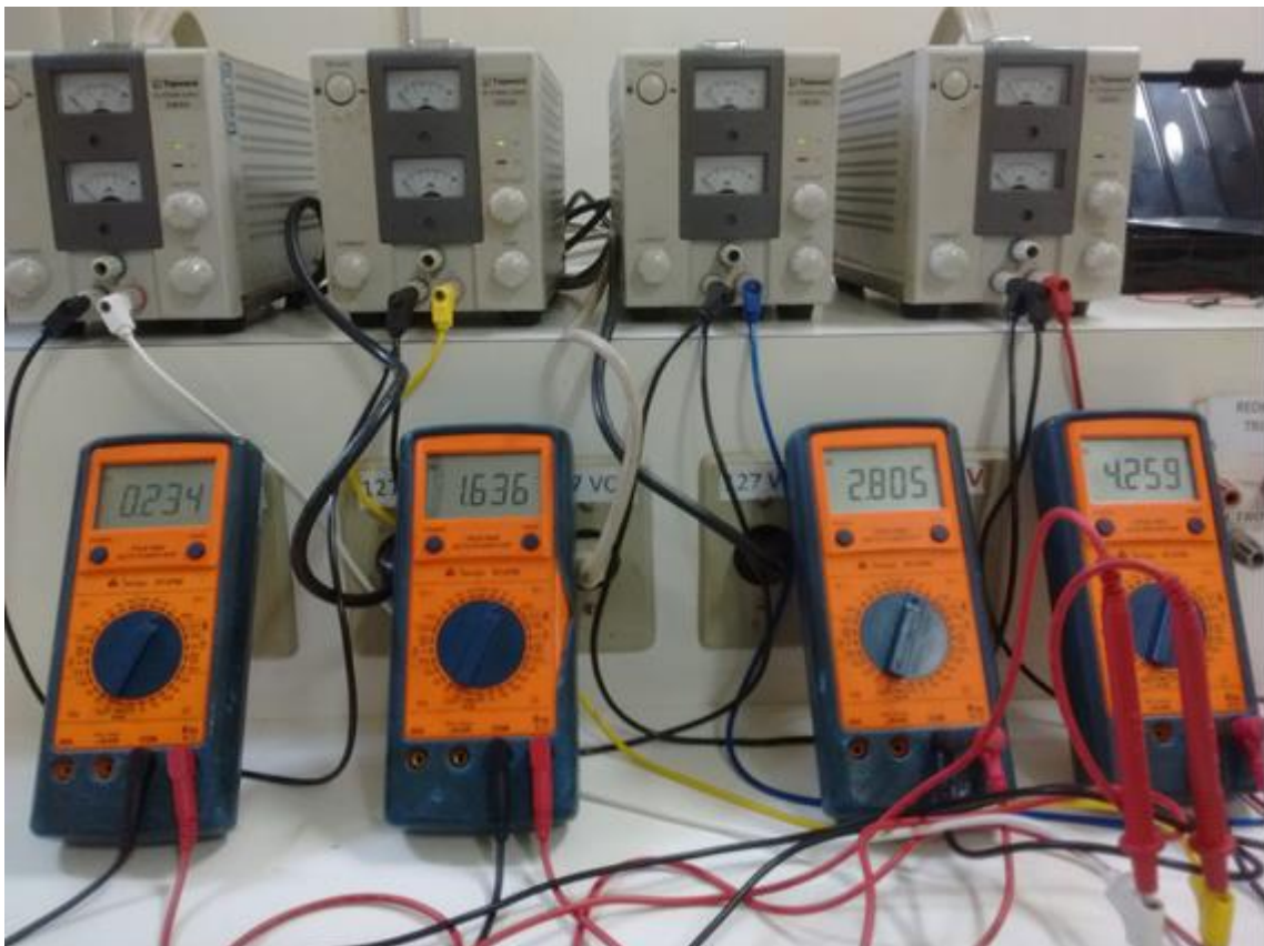
Figura 31: Valores de tensão intermediários aplicados nas entradas A3, A2, A1 e A0 do Arduino respectivamente.
