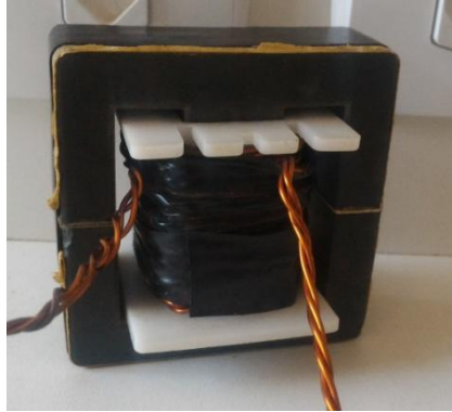
Figura 46: Indutor utilizado de 400\mu\text{H}
