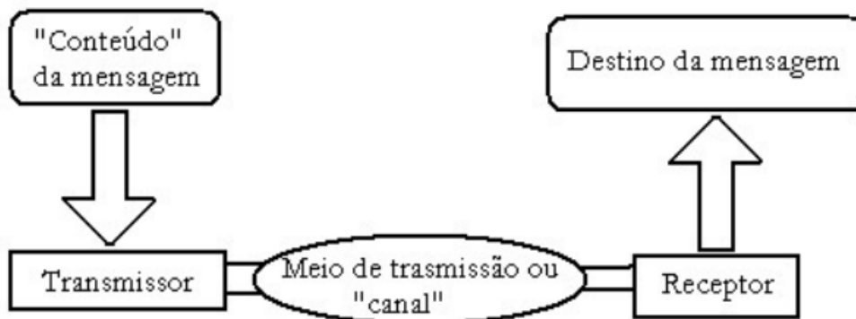
Figura 12: Formato de um sistema de comunicação
