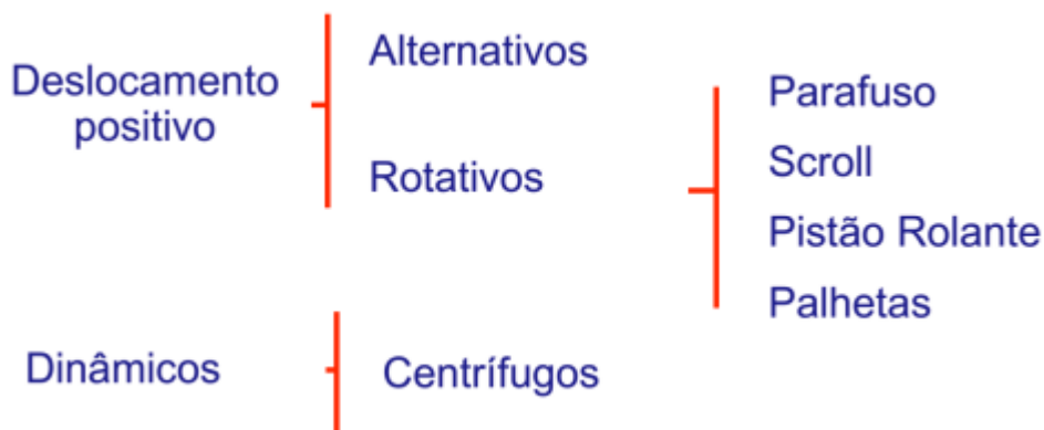
Figura 7: Classificação dos compressores
