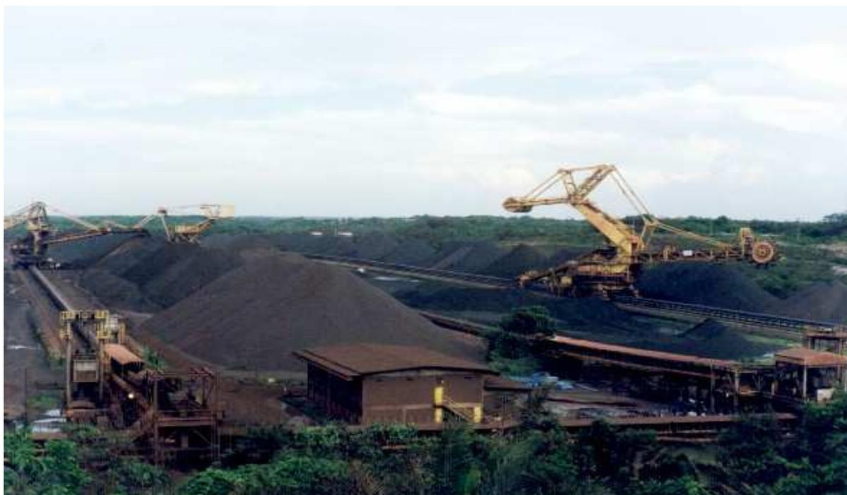
Figura 4: Pátio de homogeneização, pilhas do tipo *Chevron*.
