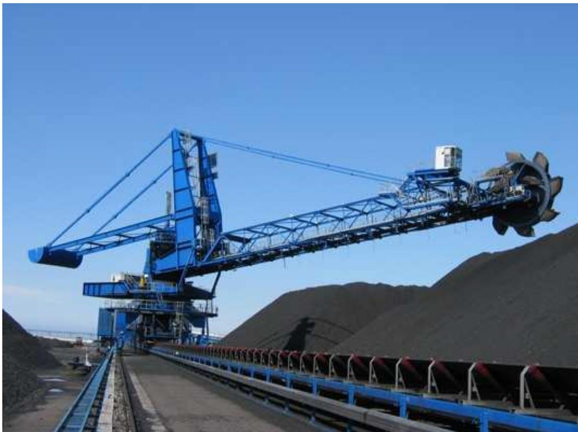
Figura 5: Máquinas de pátio, stacker-reclaimer.
