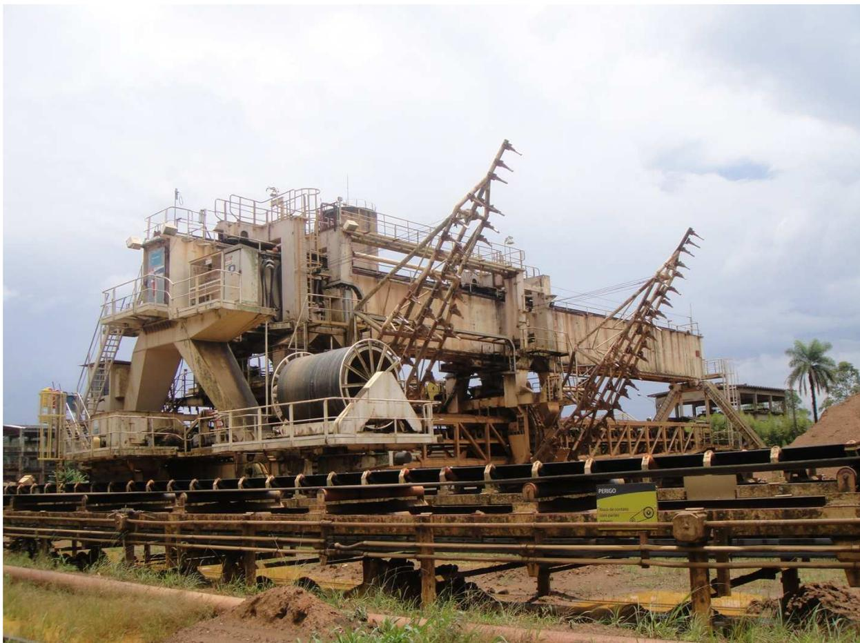
Figura 8: Máquinas de pátio, retomadora vista anterior.
