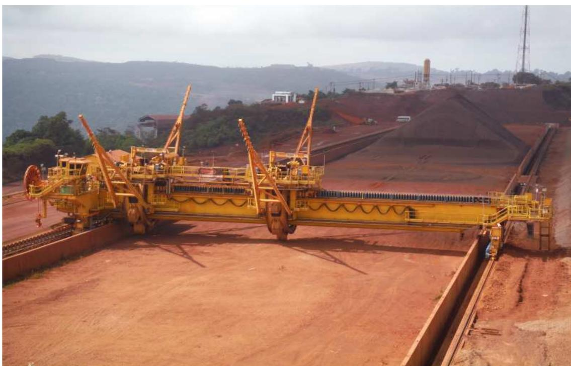
Figura 6: Máquinas de pátio, retomadora tipo ponte.
