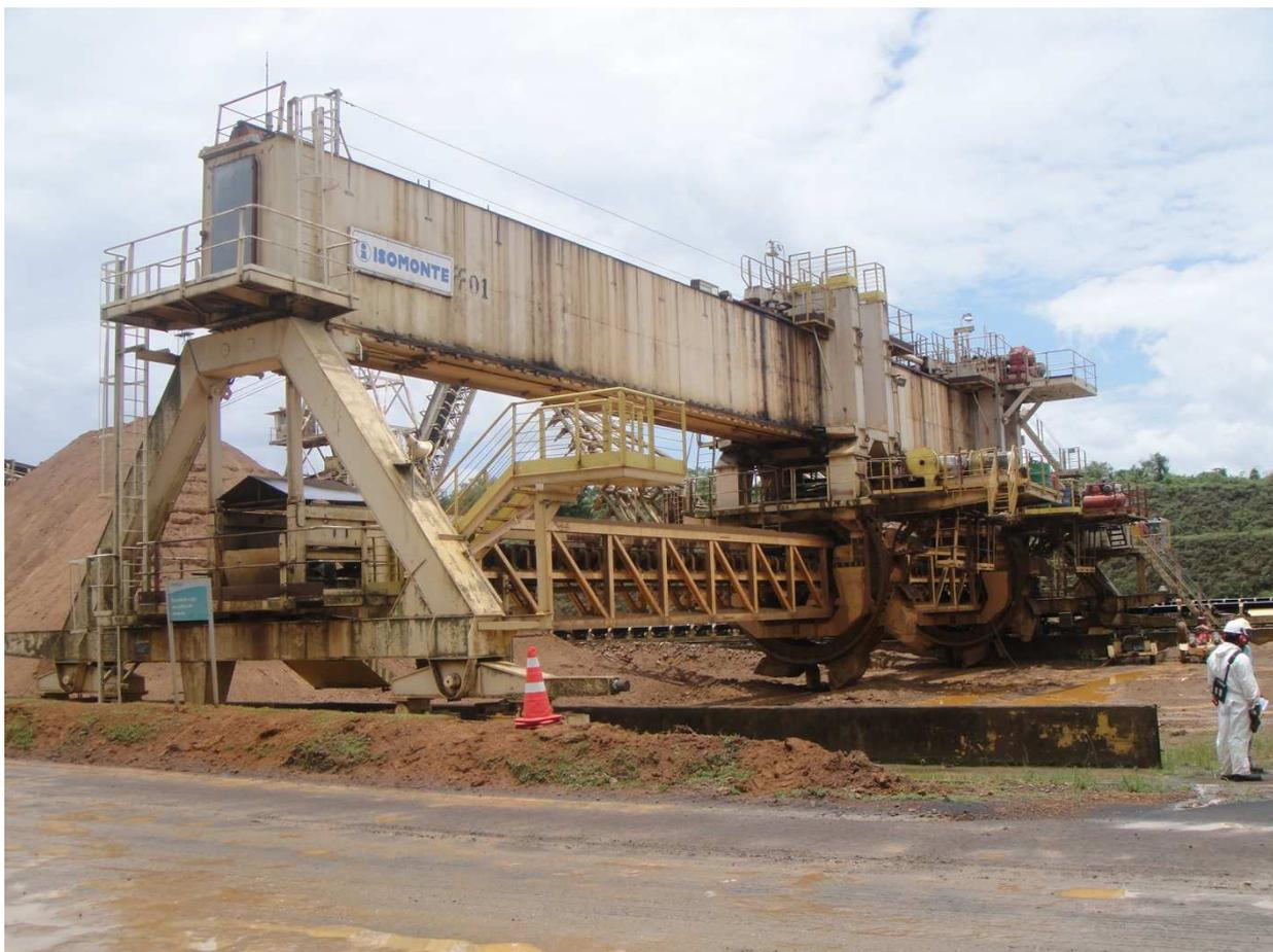
Figura 7: Máquinas de pátio, retomadora vista posterior.
