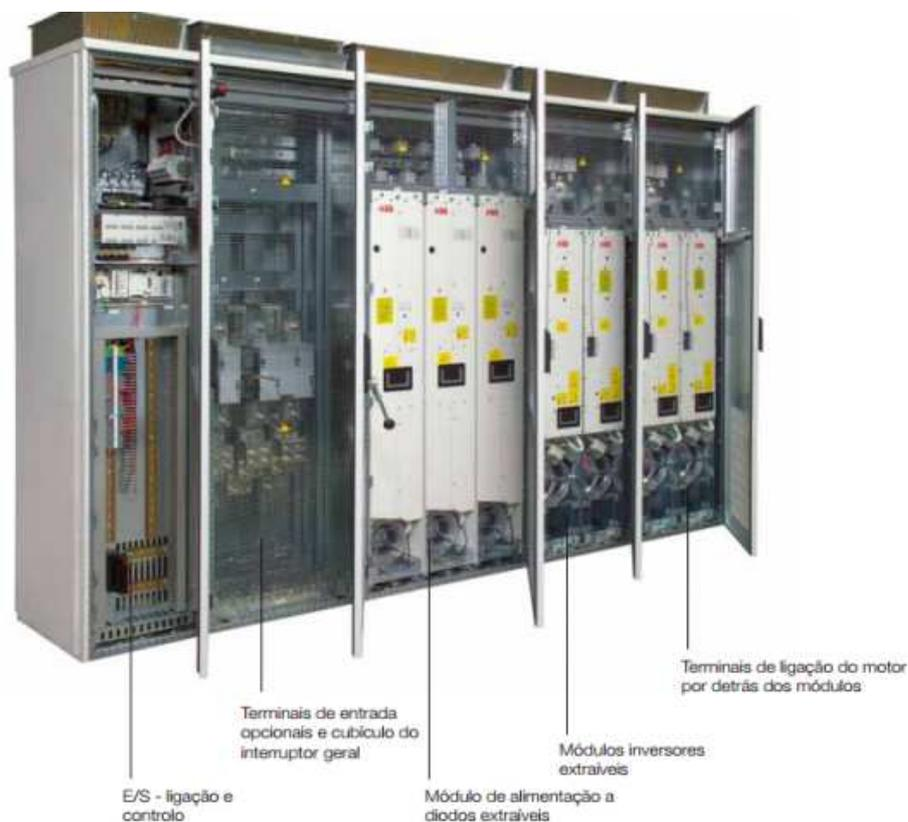
Figura 17: Inversores de frequência ABB, unidades construídas em armários.
