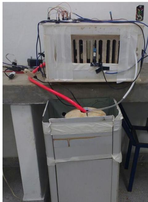
Figura 22 – Sistema híbrido de climatização implementado.
